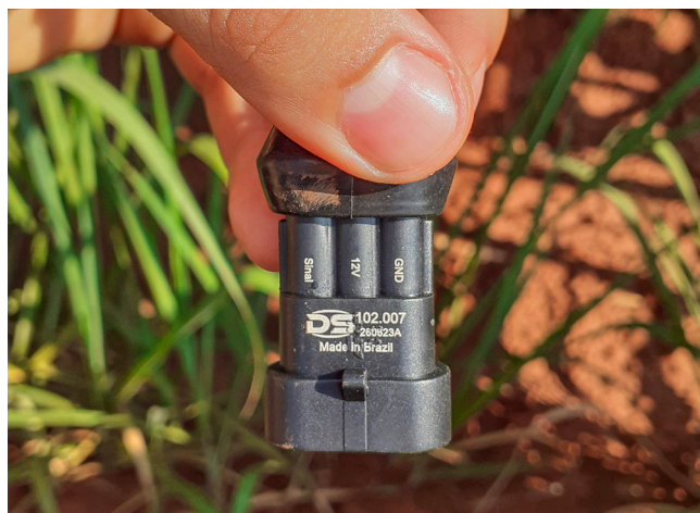
Imagem 02 - pinagem eletrônica gravada no sensor DS
