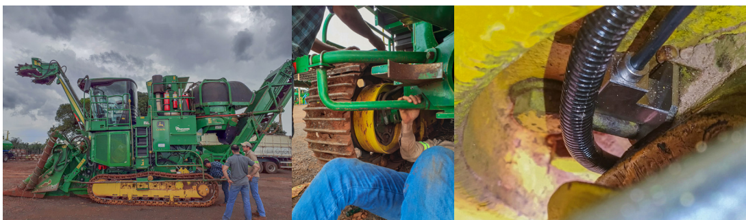
Imagem 01 - Sensor DS-125.001 aplicado em uma Colheitadeira John Deere CH570 2022
