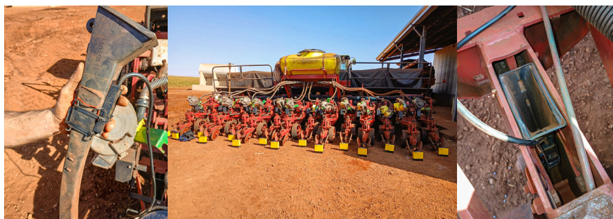
Imagem 01 - Sensor de semente aplicado em uma plantadeira Land master da Semeato
