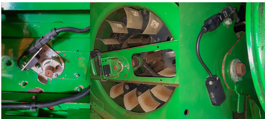
Imagem 01 - Sensor DS-118.005 aplicado em algumas posições da S540:
