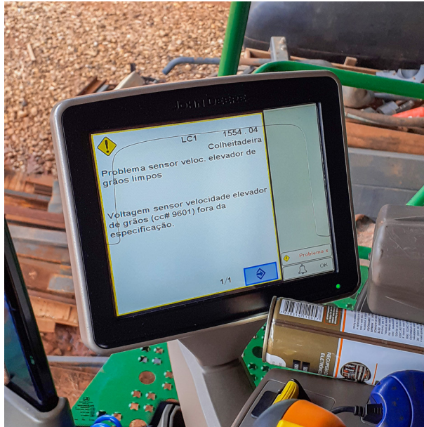
Imagem 02 - Alarme visual, indicando um defeito no sensor:
