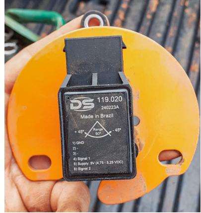
Sensor DS instalado no suporte
