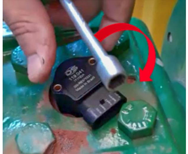
Após o encaixe correto na posição inicial, basta girar sensor no sentido horário até bater a furação do sensor em relação a máquina, instalar os parafusos e realizar o aperto dos mesmos.
