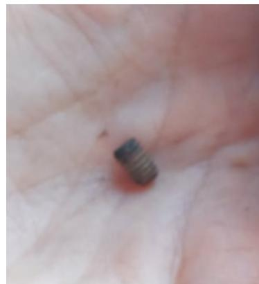
O braço da máquina é preso no eixo do sensor por um parafuso allen e possui posição de encaixe do braço em relação ao eixo.
