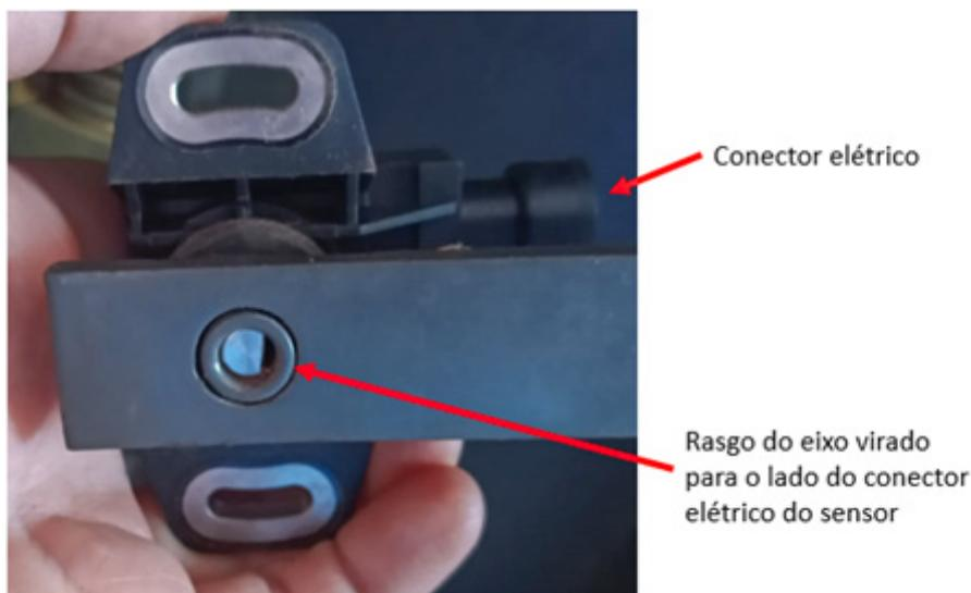
**D**- Após encaixe do braço ao eixo do sensor, instale o parafuso allen para fixação, conforme a imagem abaixo:
