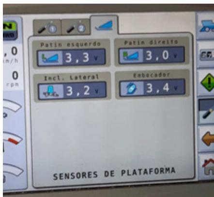
**Nota:** O valor de tensão irá variar conforme a posição angular do sensor, isso é, conforme a posição da plataforma. Caso a plataforma esteja nas posições citadas acima e os valores de tensão não serem os citados, os sensores não iram funcionar corretamente, desse modo, é necessário realizar a calibração dos sensores, conforme descrito abaixo.
