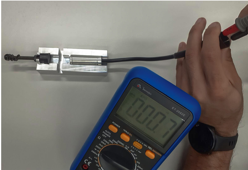
Imagem 05 - Teste de continuidade no sensor DS500003:
